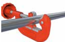
1. Corte de tubo 1. Cortar o tubo
