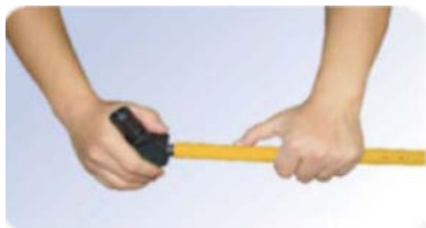
2.- Aborcardar y Redondear 2.- Abocardar e Arredondar
