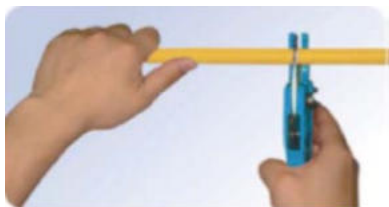
1.- Corte de tubo 1.- Cortar o tubo
