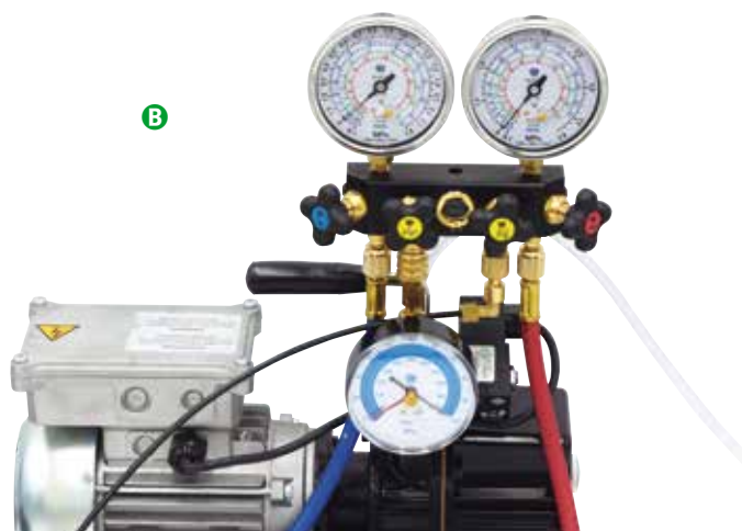
Detalle del kit equipado con electroválvula y vacuómetro
