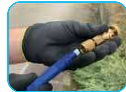
Colocación de nueva junta
