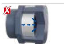
Aplicación tapón r/h tradicional con cinta PTFE. Traditional r/t plug application with PTFE.
