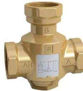
Válvula de 3 vías de accionamiento termostático que mantiene la temperatura de retorno a la caldera por encima de 55 °C, para evitar condensación de los gases de combustión. Baja pérdida de carga, funcionamiento completamente autónomo sin necesidad de regulación.
