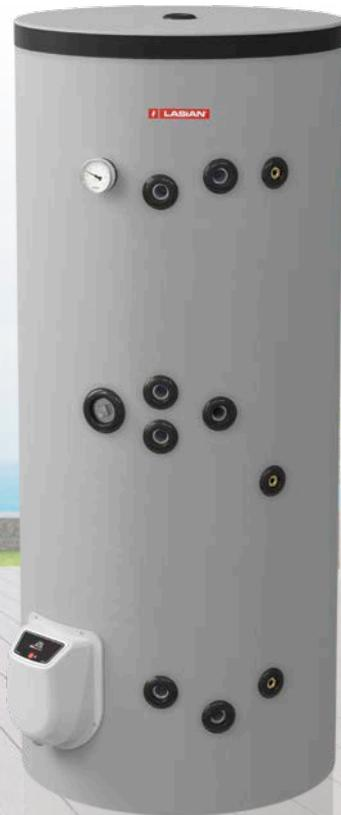
Depósitos de acero vitrificado líquido con doble serpentín. El serpentín inferior está diseñado para utilizar una fuente de calor externa procedente de una caldera, el serpentín superior utiliza fuentes de calor de captadores de energía solar.
