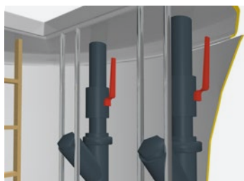
Válvulas de corte y antirretorno.
