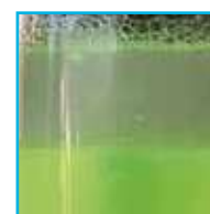
Refrigerante y aditivo con contaminación de agua
