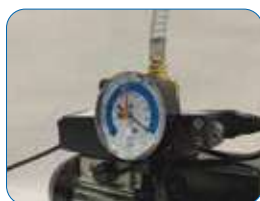
Conexión con bomba de vacío
