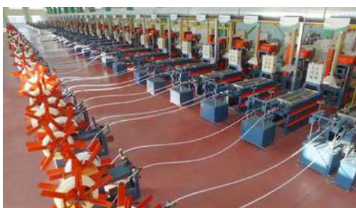
125 líneas de producción de tubos PEX-a por método Engel.
