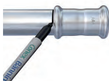
4. Marcar la inserción 4. Marcar ponto da inserção
