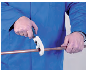
1. Corte de tubo 1. Cortar o tubo
