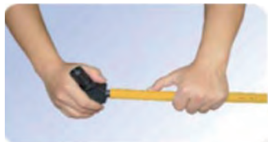
2.- Aborcardar y Redondear 2.- Abocardar e Arredondar
