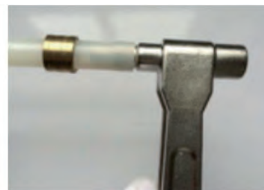
2. Abocardamos el tubo 2. Abocardamos o tubo
