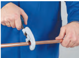
1. Corte de tubo 1. Cortar o tubo
