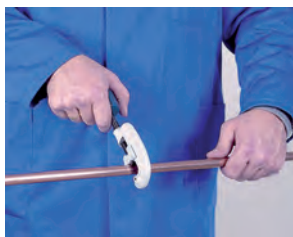
1. Corte de tubo 1. Cortar o tubo
