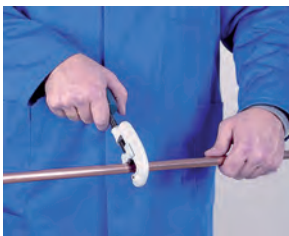
1. Corte de tubo 1. Cortar o tubo
