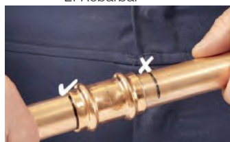
5.- Inserción del tubo en el accesorio 5.- Encaixar o tubo no acessório
