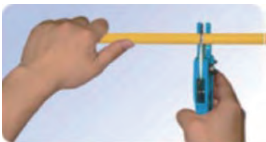
1.- Corte de tubo 1.- Cortar o tubo
