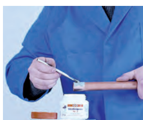
4. Aplicación del decapante 4. Aplicação do decapante
