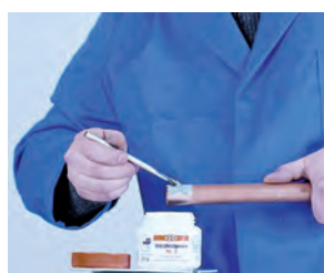
4. Aplicación del decapante 4. Aplicação do decapante
