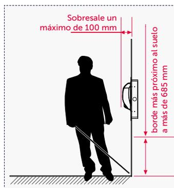
El secador de manos y el kit de montaje en la pared sobresalen horizontalmente 90 mm conforme a la normativa ADA que limita a 100 mm la proyección horizontal de los dispositivos instalados en aseos públicos.
