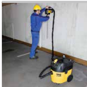
Aspirador y eliminador de polvo certificado para capturar polvo nocivo para la seguridad según EN 60335-2-69.
