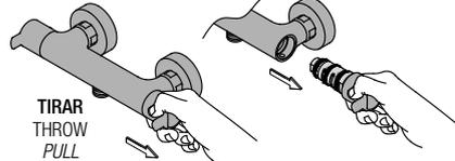
5 **Introducir el nuevo cartucho termostático** · Introduce the new thermostatic cartridge · *Introduire la nouvelle cartouche thermostatique.*
