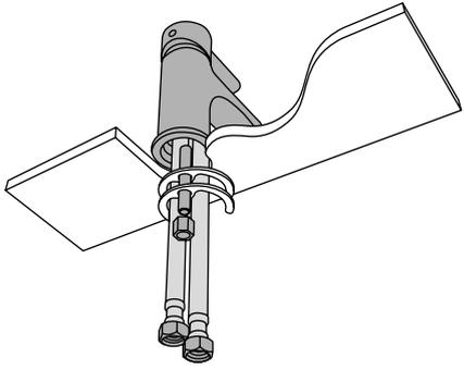
**colocación de latiguillos / flexible hoses assembly /**
