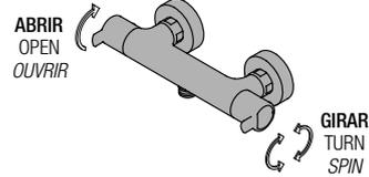
3 **Soltar el tornillo que sujeta el cartucho termostático con la llave allen** · Remove the screw that holds the thermostatic cartridge with the Allen key supplied · *Déviser la vis qui fixe la cartouche thermostatique avec la clef allen fournie.*
