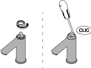
4 **Soltar la tuerca aprietacartuchos** · Remove the cartridge nut · *Déviser l'écrou pour cartouche.*
