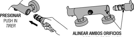
6 **Volver a introducir el tornillo con la llave allen y apretar hasta que el tornillo quede oculto en el grifo** · Install the screw with the Allen key supplied and tighten until the screw is hidden in the valve · *Viser la vis avec la clé allen et serrer jusqu'à quelle reste invisible dans le robinet.*
