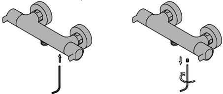
4 **Extraer el cartucho termostático tirando de la maneta** · Extract the thermostatic cartridge pulling the handle · *Extraire la cartouche thermostatique en tirant de la poignée.*
