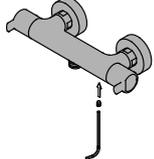
7 **Para testear de nuevo el grifo, abra ambas llaves de paso, ya que este producto necesita las dos entradas de agua de manera simultánea. El grifo termostático quedará automáticamente calibrado gracias al sistema GRB LIVE** · Open both stop valves, the thermostatic mixer will automatically remain calibrated thanks to the GRB LIVE system · *Ouvrir à nouveau les deux robinets d'arrêt. Le robinet na pas besoin d'être calibré dû au système GRB live.*
